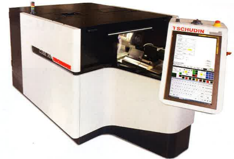
Bild 2: Die Außenrund-Schleifmaschine Tschudin Cube 350 überzeugt durch maximale Effizienz auf minimaler Fläche und kurze Rüstzeiten (Bilder: Tschudin AG, CH-Grenchen)
